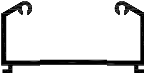
3587-30 U Bağlantı Profili 1.193 Kg/m
