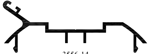
3556-14 Kapı Adaptörü 0.463 Kg/m
